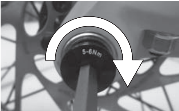
Abbildung 30: Sicherungsschraube anziehen
