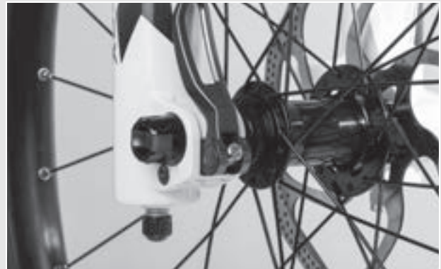
Abbildung 37: Perfekte Lage des Spannhebels
