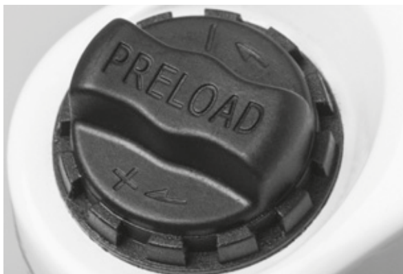
Afbeelding 45: Afstelwiel voor de sag op de kroon van de verende voorvork
