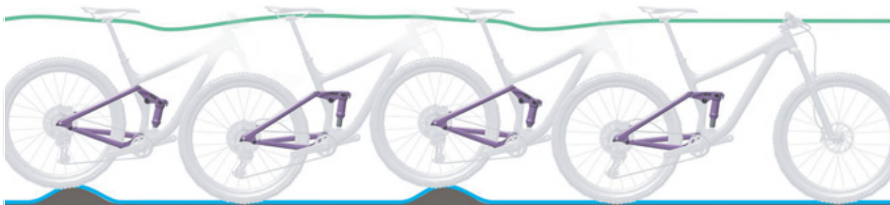
Afbeelding 49: Optimaal rijgedrag van de achterbouwdemper
