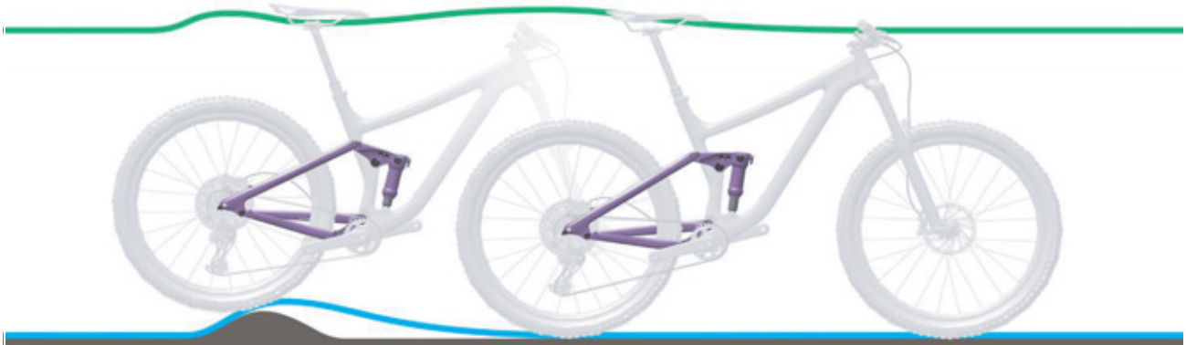
Afbeelding 86: Te harde demping van de achterbouwdemper bij oneffenheden
