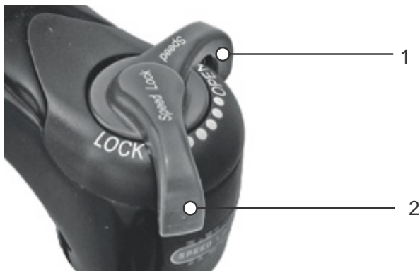
Afbeelding 77: Suntour drukdemper in open (1) en gesloten (2) stand
