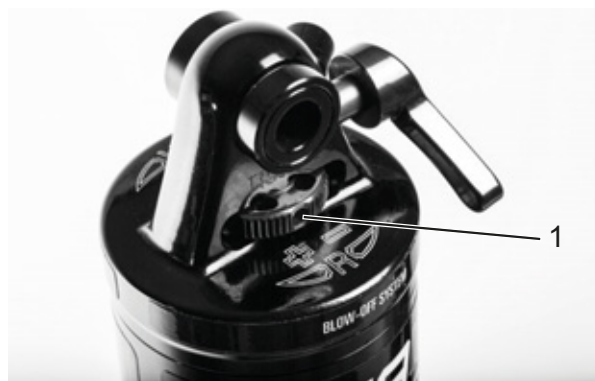
Afbeelding 51: Wiel (1) van de Suntour trekdemperafsteller op de achterbouwdemper
