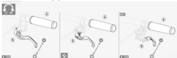
Afbeelding 43: Grijpafstand Magura schijfremhendel afstellen
