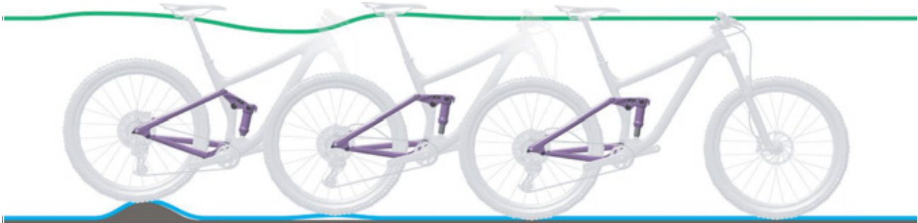
Afbeelding 80: Te snel uitveren van de achterbouwdemper
