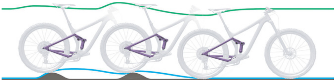
Afbeelding 82: Te langzaam uitveren van de achterbouwdemper
