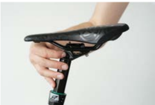
102. ábra: Nyereg dőlésszögének beállítása a beállító kerékkel
