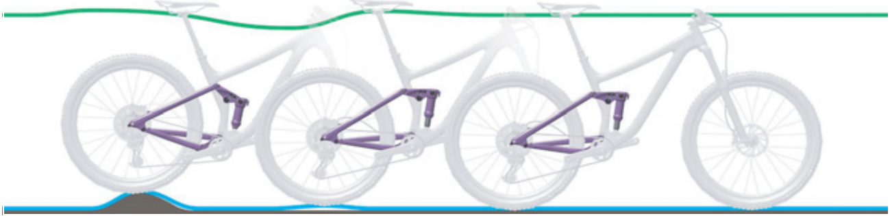
279. ábra: A hátsó lengéscsillapító túl gyors kirugózása
