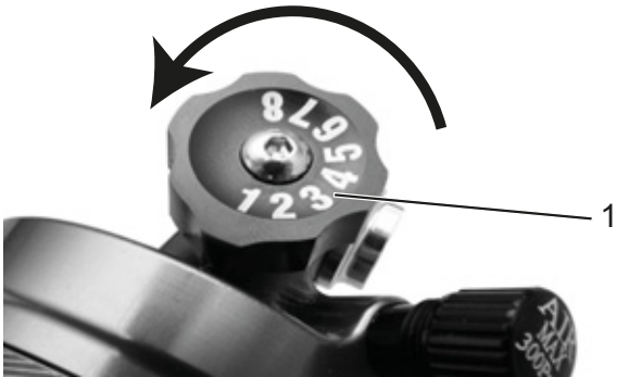
146. ábra: Suntour nyomásfokozat-beállító (1) a hátsó lengéscsillapítón
