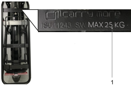
159. ábra: A csomagtartón fel van tüntetve maximális teherbírása (1)
