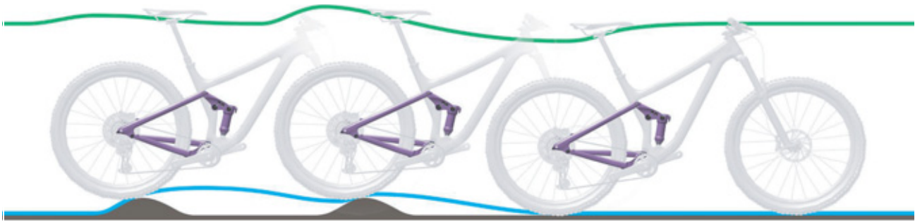
273. ábra: A hátsó lengéscsillapító túl lassú kirugózása
