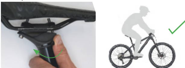
96. ábra: A nyeregcsőtengely meghúzása
