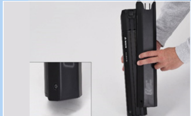
67. ábra: Az akkumulátorfedél rátolása az akkumulátorra
