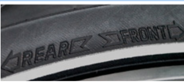
69. ábra: Futásirányjelző nyíl MTB gumiabroncsokon
