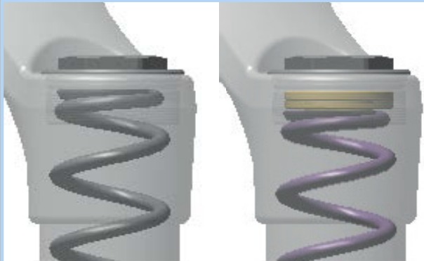
137. ábra: Előfeszítés-beállítógyűrű befelé és kifelé forgatása
