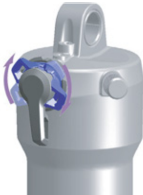
149. ábra: A nyomásfokozat-beállító keményebb beállítása
