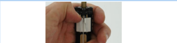
219. ábra: Fehér működtető kapcsoló lefelé tolása
