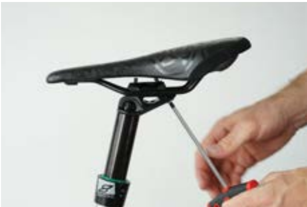
101. ábra: Hátsó csavar meglazítása
