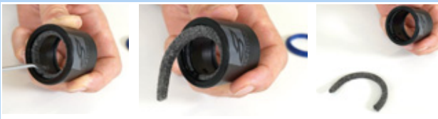
239. ábra: A filcgyűrű eltávolítása
