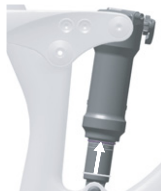
139. ábra: O-gyűrű eltolása a hátsó lengéscsillapítón
