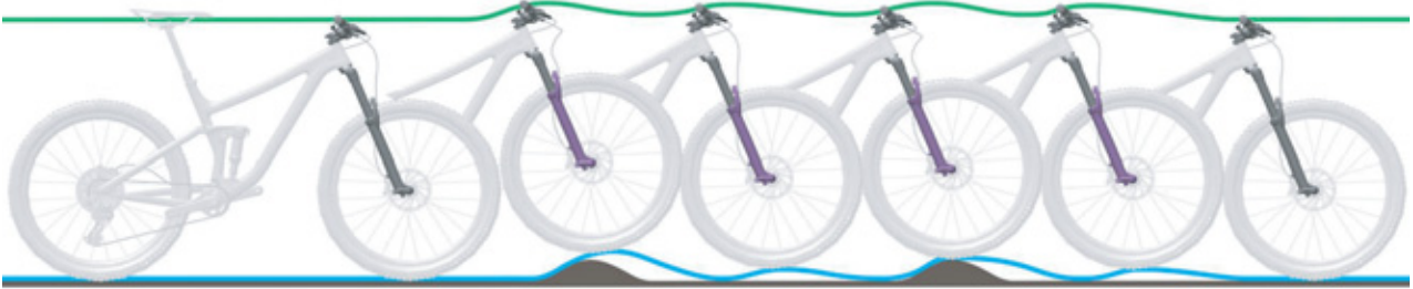
263. ábra: A teleszkópos villa túl gyors kirugózása
