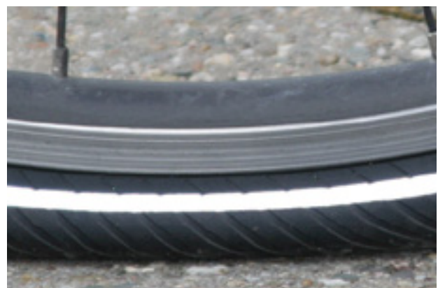
117. ábra: Túlontúl alacsony töltőnyomás
