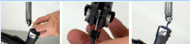
251. ábra: A nyeregcső felakasztása és betolása
