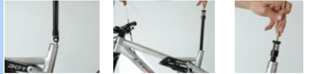
221. ábra: Tubus szelepfedél rögzítése
