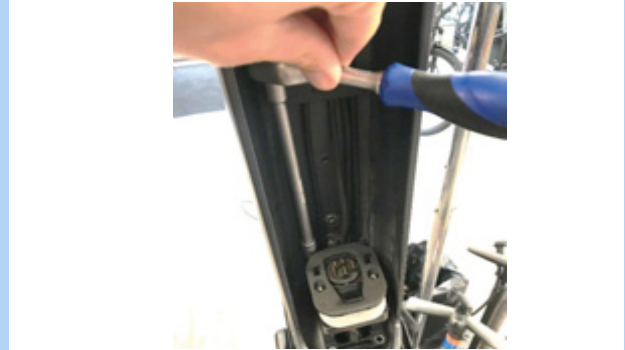
57. ábra: Belső hatlapfejű csavarok eltávolítása
