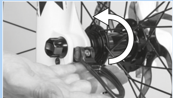
77. ábra: A gyorsár nyomása nyílrányban
