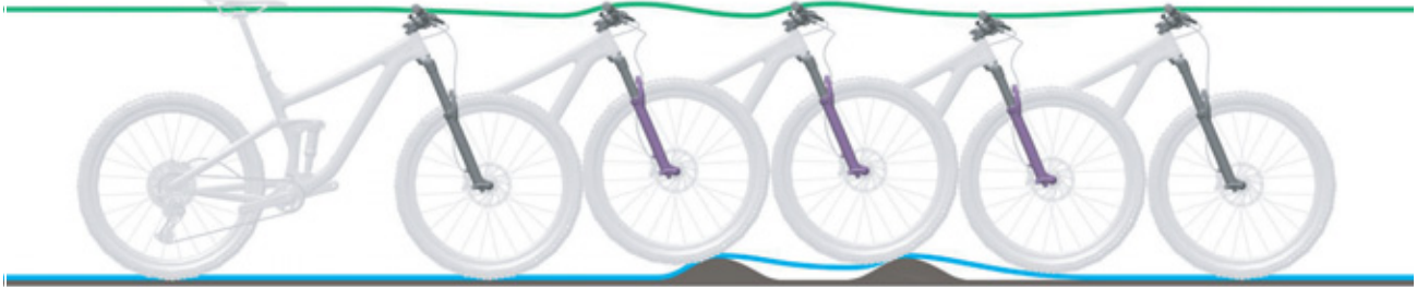
265. ábra: A teleszkópos villa túl lassú kirugózása
