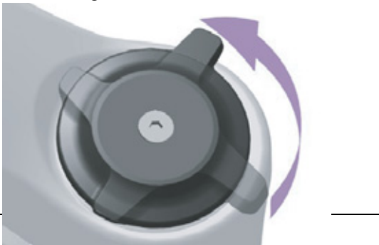
172. ábra: A nyomásfokozat-beállító puhább beállítása
