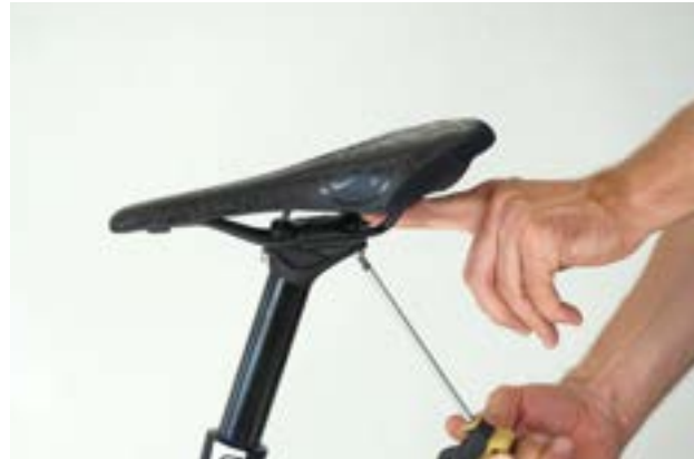
99. ábra: Hátsó csavar meglazítása
