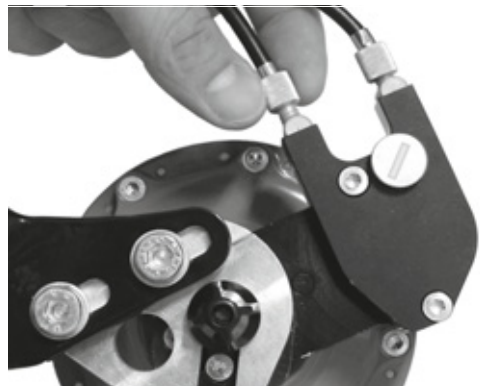
186. ábra: Külső váltóvezérléssel rendelkező Rohloff agyváltozatok húzásbeállítója a kötéldobozon van, ami a bal oldalon található
