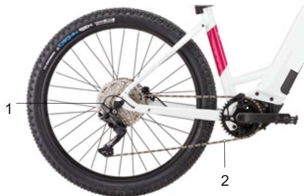
34. ábra: Külső váltóval felszerelt lánchajtás vázlata
