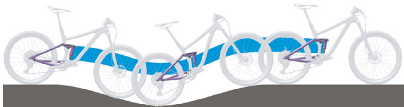
22. ábra: A hátsó lengéscsillapító optimális menetviselkedése dombos terepen
