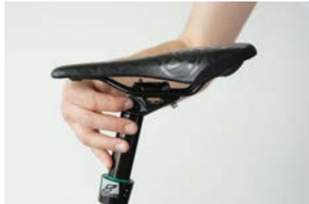
106. ábra: Nyereg dőlésszögének beállítása a beállító keréssel
