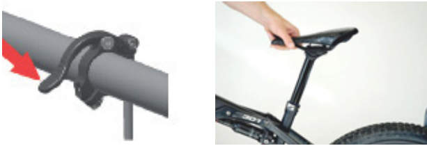
94. ábra: Hidraulikus gázrugó kiengedése
