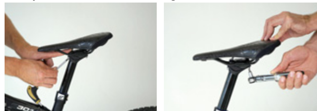
100. ábra: Első és hátsó csavar rögzítése
