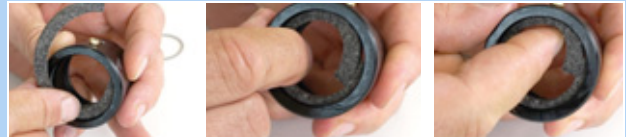
241. ábra: Filcgyűrű behelyezése
