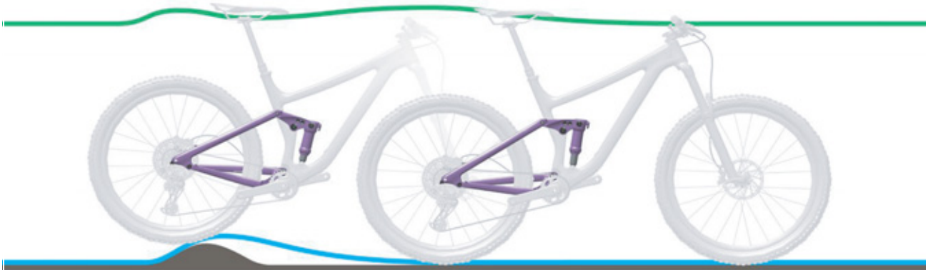
285. ábra: A hátsó lengéscsillapító túl kemény csillapítása egyenetlenségeknél
