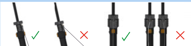
220. ábra: Helyesen és hibásan beállított bovdent
