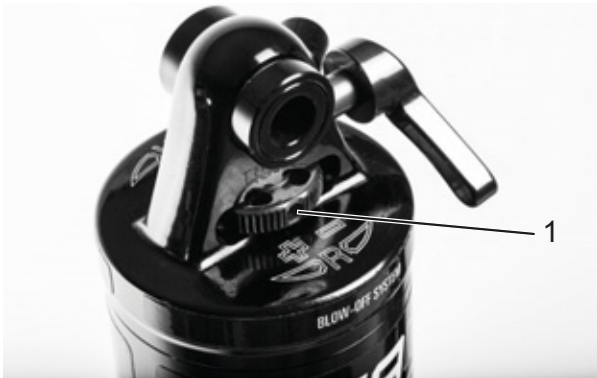
274. ábra: Suntour kerék húzófokozat-beállító (1) a hátsó lengéscsillapítón
