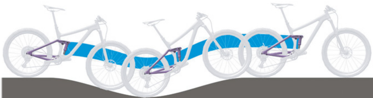
17. ábra: A hátsó lengéscsillapító optimális menetviselkedése dombos terepen
