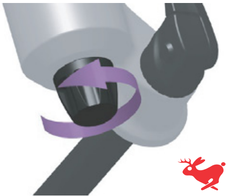
266. ábra: A húzófokozat csavar fordítása a nyúl irányába
