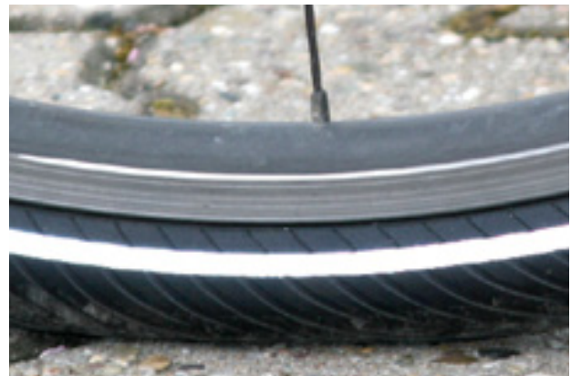
116. ábra: Helyes töltőnyomás. A gumiabroncs alakja a testsúly terhe alatt alig változik
