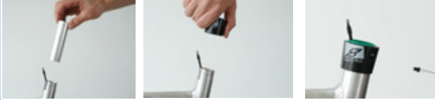
250. ábra: Siklópersely és külső hüvely beépítése
