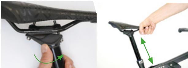
95. ábra: A nyeregcső magasságának beállítása
