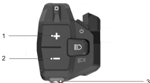
Rysunek 121: Położenie przycisków Plus (1), Minus (2), i mechanizmu wspomagającego pchanie (3)
