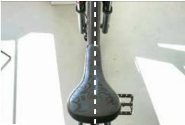
Rysunek 74: Ustawianie siodełka zgodnie z kierunkiem jazdy
