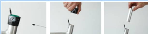
Rysunek 189: Demontaż tulei zewnętrznej i tulei ślizgowej
