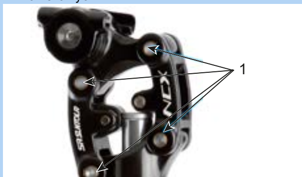
Rysunek 146: Punkty smarowania amortyzowanej sztycy podsiodłowej Suntour SR
