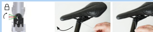
Rysunek 184: Zamykanie mechanizmu regulacji wysokości
