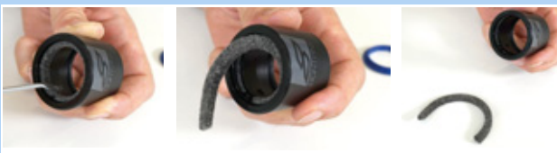
Rysunek 193: Wyciąganie pierścienia filcowego
