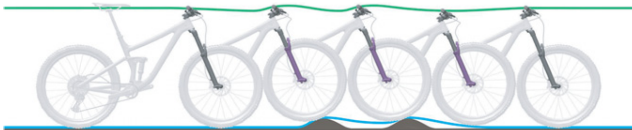
Rysunek 211: Zbyt wolne rozprężanie widełca amortyzowanego
