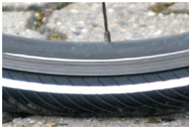
Rysunek 91: Prawidłowe ciśnienie w oponach. Opona prawie nie odkształca się pod wpływem ciężaru ciała
