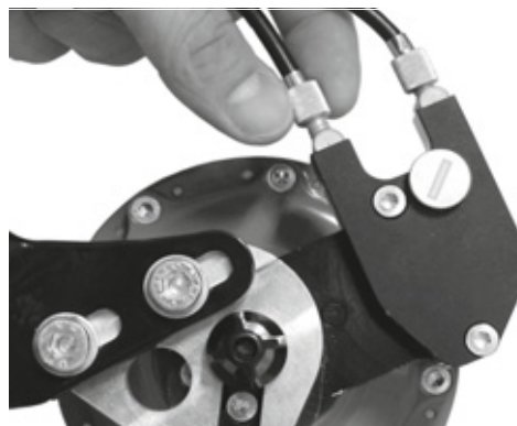
Rysunek 140: Wersje piast Rohloff z zewnętrznym sterowaniem zmiany biegów mają regulator linki na przepustnicy kablowej, która znajduje się po lewej stronie
