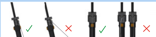
Rysunek 174: Prawidłowa i nieprawidłowa pozycja cięgna Bowdena
