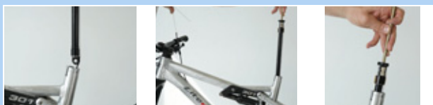
Rysunek 175: Mocowanie nakrętki zaworu wkładu
