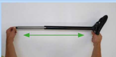
Rysunek 199: Rozsuwanie sztycy podsiodłowej
