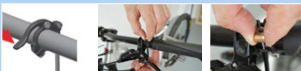
Rysunek 149: Demontaż wkładu
