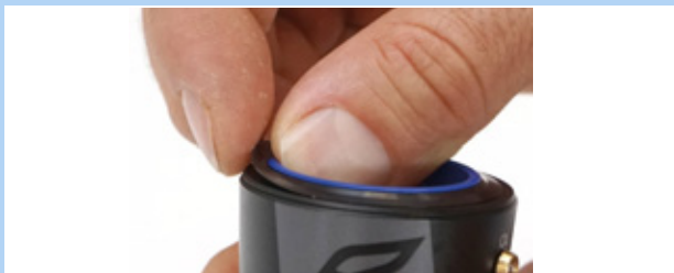
Rysunek 190: Ściąganie wargowego pierścienia uszczelniającego
