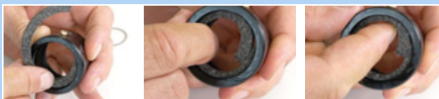
Rysunek 160: Wkładanie pierścienia filcowego
