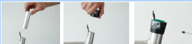
Rysunek 171: Montaż tulei ślizgowej i tulei zewnętrznej
