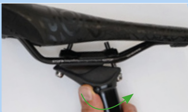
Rysunek 198: Otwieranie mechanizmu regulacji wysokości
