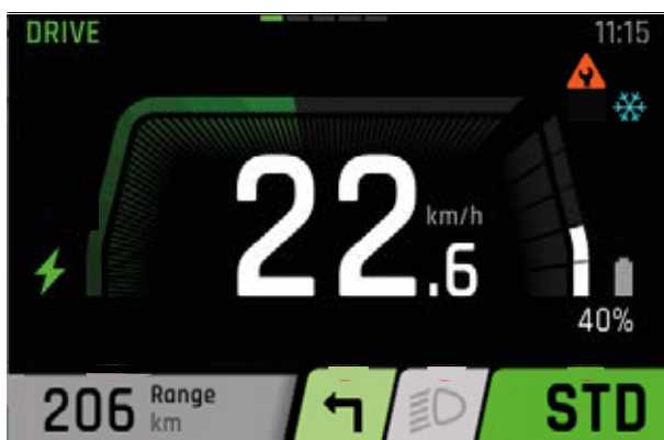
Rysunek 109: Zrzut ekranu MENU GŁÓWNEGO DRIVE FIT Comfort
