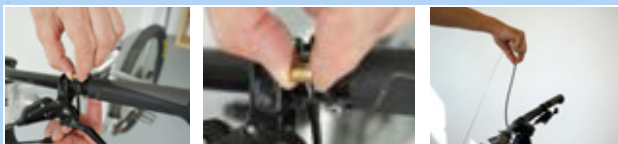
Rysunek 186: Odkręcanie zdalnego sterowania
