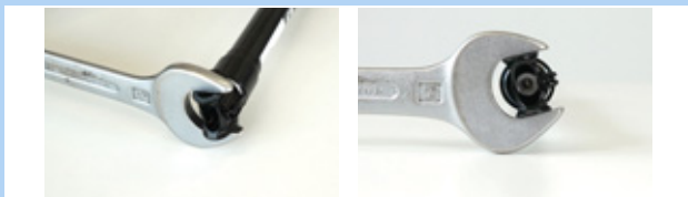
Rysunek 168: Zabezpieczenie przed przekręceniem się
