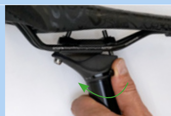
Rysunek 203: Zamykanie mechanizmu regulacji wysokości
