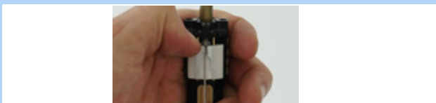
Rysunek 173: Przesuwanie białego przełącznika w dół
