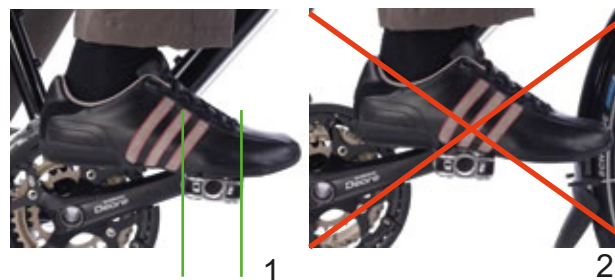
Rysunek 116: Prawidłowe (1) i nieprawidłowe (2) ułożenie stopy na pedale
