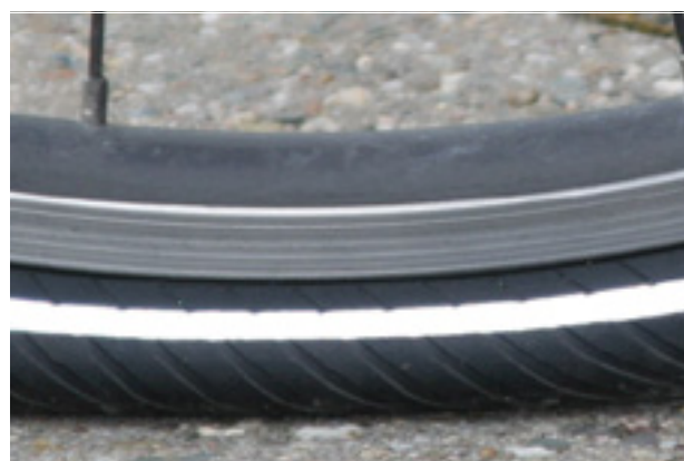
Figura 98: Pressione di gonfiaggio insufficiente
