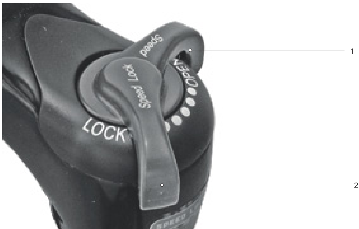
Figura 127: Ammortizzatore a stadi di pressione Suntour in posizione aperta (1) e chiusa (2)
