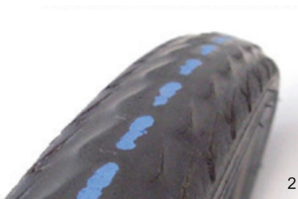
Figura 137: Pneumatico senza profilo ancora utilizzabile (1) e pneumatico con protezione contro le forature in vista (2) che deve essere sostituito
